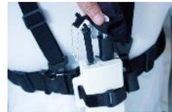
3. Den mit den Leuchtbändern TEXTLIGHT1-V2 mitgelieferten Zählerstick in den dafür vorgesehenen Anschluss auf der Oberseite des Zwischengehäuses einstecken. Er muss während der gesamten Behandlung angeschlossen bleiben.
