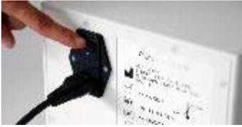
2. Allumer la source en appuyant sur le bouton bistable ON (I) / OFF (O) situé à l'arrière de la source lumineuse.
