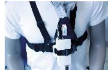
4. Das Metallende (Stecker) der Leuchtbänder TEXTLIGHT1-V2 in den Anschluss am Zwischengehäuse einführen (sicherstellen, dass die Schutzkappe vorher entfernt wurde).
