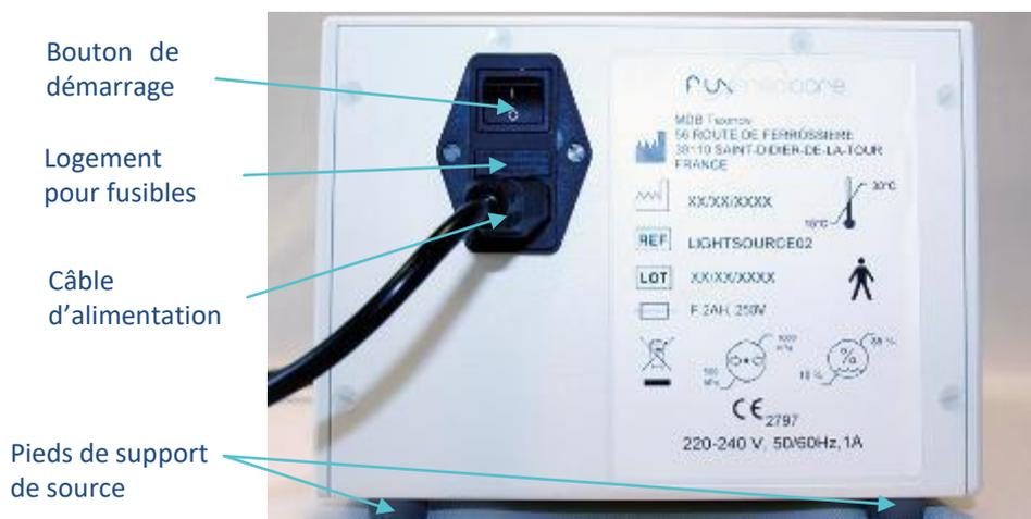
La face arrière de la source lumineuse (cf. Schéma 2) se compose :
