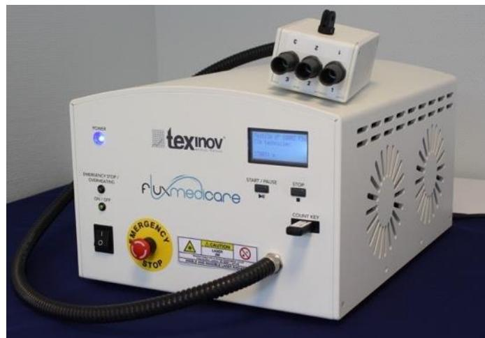
Des bouchons sont placés sur les connecteurs du boîtier intermédiaire.
