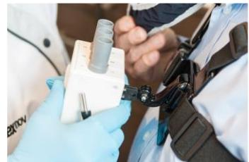
3. Connecter les trois connecteurs sur le boîtier intermédiaire. Ceux-ci doivent être au-dessus du harnais.
