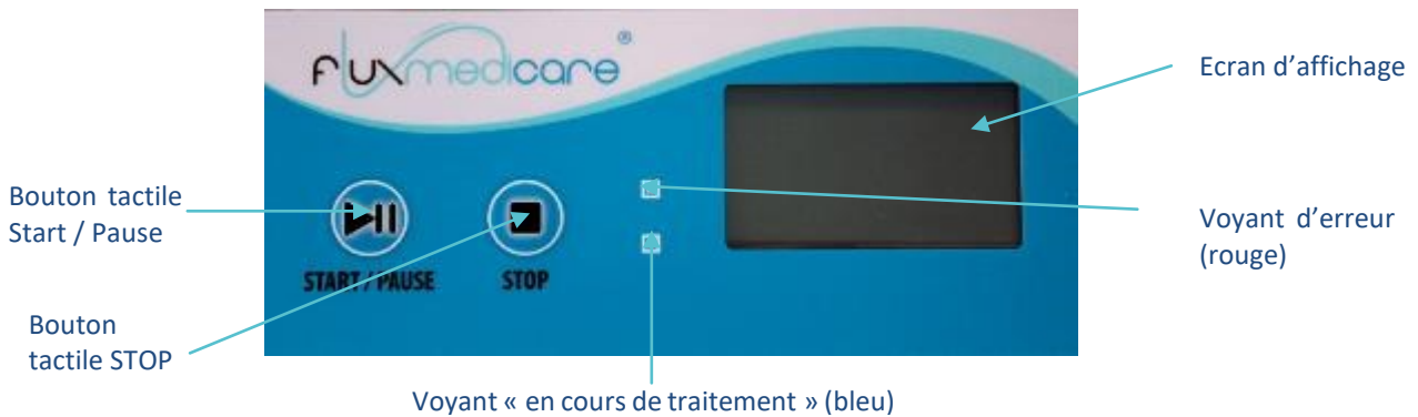
Schéma 1 : Face avant de la source lumineuse
