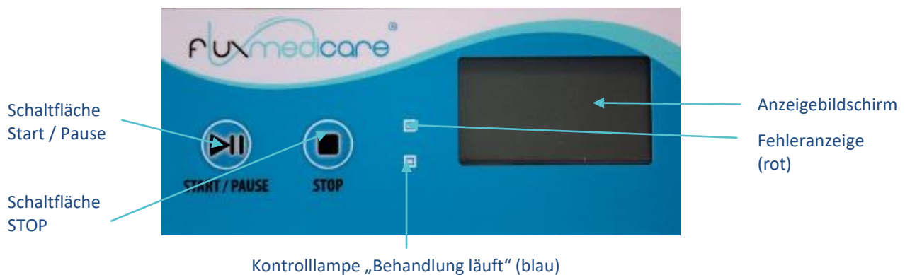
Abbildung 3: Vorderseite der Lichtquelle
