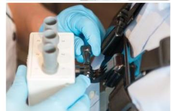
3. Die drei Stecker am Zwischengehäuse anschließen. Diese müssen oberhalb des Haltegurts liegen.
