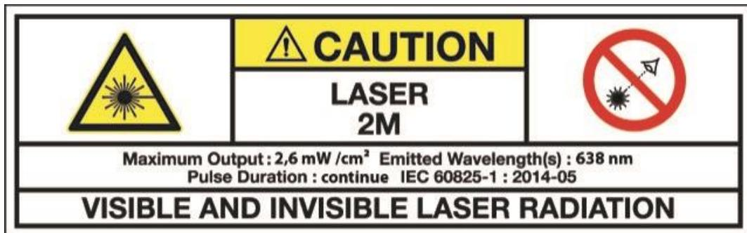
Émission maximale : 2.6 mW/cm<sup>2</sup> - Longueur d'onde émise : 638 nm
